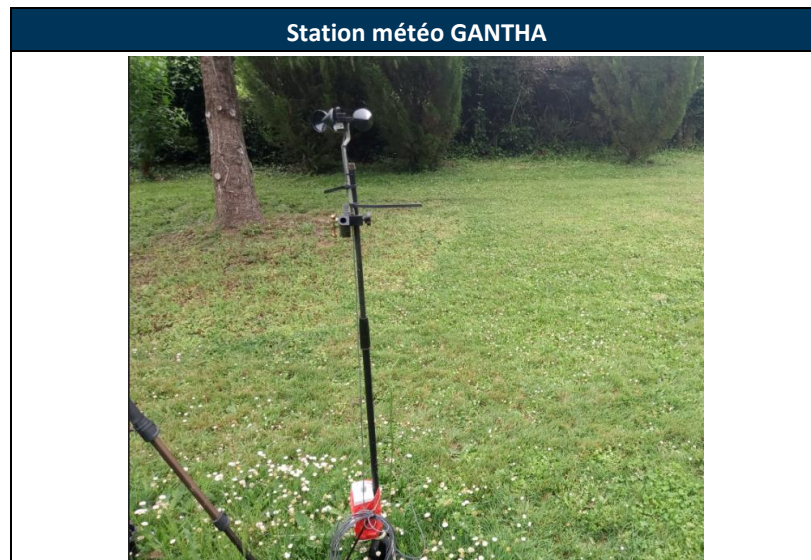
Figure 2 : Station météorologique à 1,5 m
